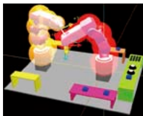
ロボットアームを立体モデルで定義して干渉チェック
