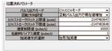
【位置決め機能 パラメータ設定例】 パルス出力モード: CW/CCWモード 回転方向設定: 正転パルス出力で現在値増加
